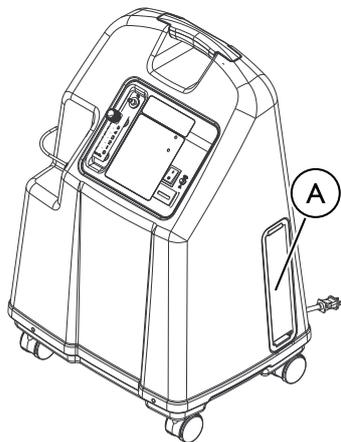
1. Den Filter **A** abnehmen und bei Bedarf reinigen.
