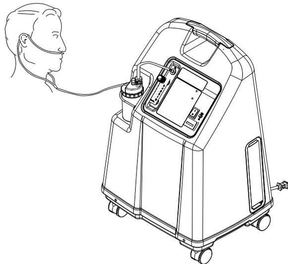
Fig. 3-2 Konzentrator mit Befeuchter
