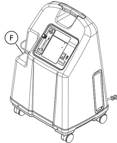
6. Beim Einsetzen der Befeuchterflasche/-adaptereinheit ins Befeuchterfach ⑥ im Konzentrator den Schlauch der Befeuchterflasche/-adaptereinheit ④ an den Sauerstoffauslassverbinder ① am Konzentrator anschließen.
