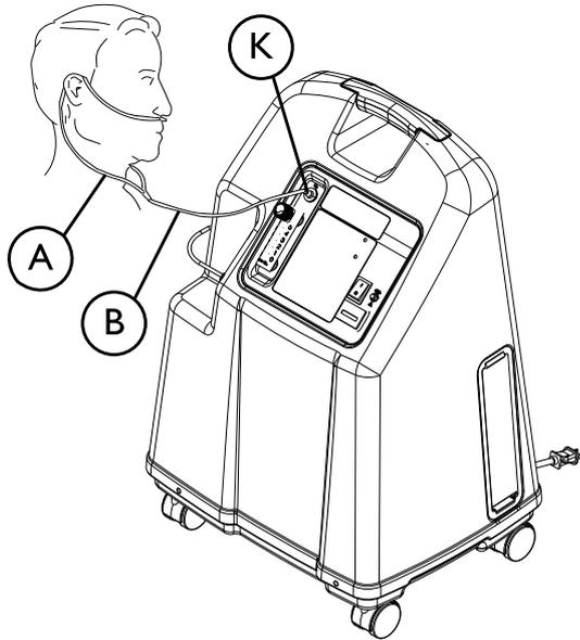
Fig. 6-1 Konzentrator ohne Befeuchter
