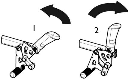
1. Zum Betätigen der Bremse ziehen Sie den Bremshebel mit den unteren Fingern so weit wie möglich nach hinten.
