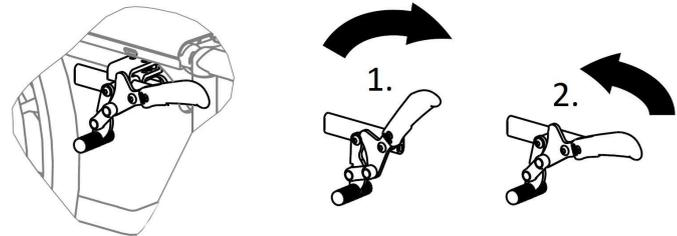
1. Zum Betätigen der Bremse drücken Sie den Bremshebel mit der Handfläche so weit wie möglich nach vorne.
