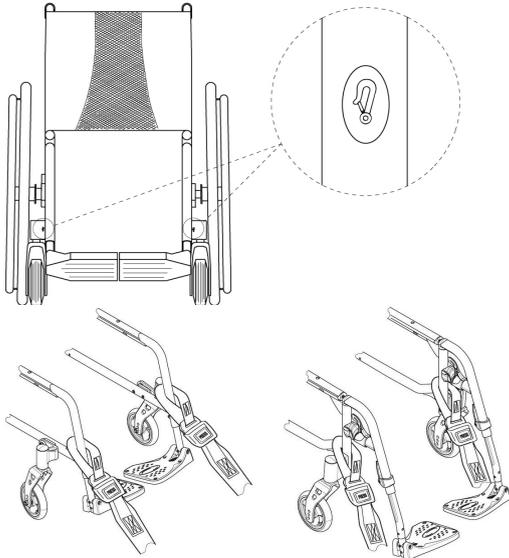
1. Befestigen Sie die vorderen Gurte wie in den beiden vorstehenden Abbildungen gezeigt oberhalb der Schwenkradhalterungen (siehe Lage der Befestigungsetiketten).
