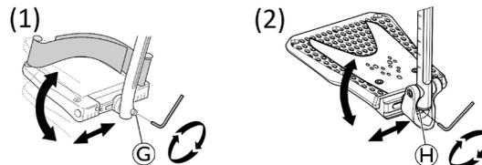
1. Lösen Sie die Fixierschraube **G** oder **H** mit einem 5-mm-Inbusschlüssel.
