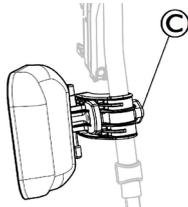
1. Lösen Sie die Knebelschraube ©.
