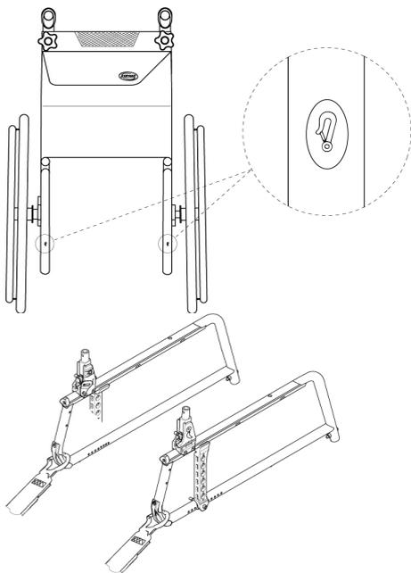
1. Befestigen Sie die Karabinerhaken wie in den beiden vorstehenden Abbildungen gezeigt am Hinterrahmen direkt über der Adapterplatte (siehe Lage der Befestigungsetiketten).
