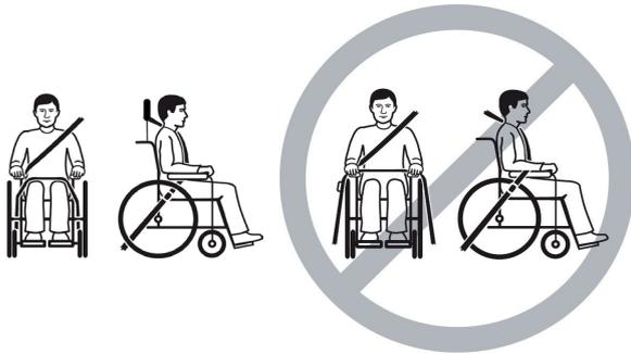
1. Bringen Sie das 3-Punkt-Personenrückhaltesystem entsprechend der Gebrauchsanweisung des verwendeten 3-Punkt-Rückhaltesystems an.
