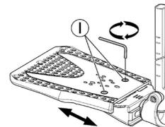
1. Lösen Sie die beiden Fixierschrauben **I** mit einem 5-mm-Inbusschlüssel.
