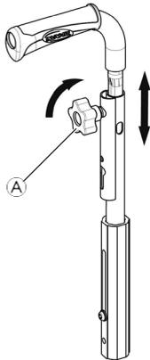
1. Um die Höhe der Schiebegriffe einzustellen, lösen Sie die Knebelschraube (A), schieben den Griff auf die gewünschte Höhe, und ziehen die Knebelschraube wieder an.
