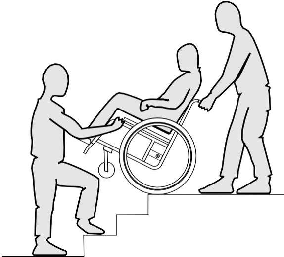
1. Treppen können überwunden werden, indem eine Stufe nach der anderen befahren wird, wie oben beschrieben. Die erste Begleitperson steht dabei hinter dem Rollstuhl und hält ihn an den Schiebegriffen. Die zweite Begleitperson umfasst einen festen Teil des Vorderrahmens und sichert so den Rollstuhl gegen vorne.
