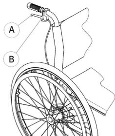
1. Ziehen Sie zum Bremsen den Bremshebel **A** am Schiebegriff.
