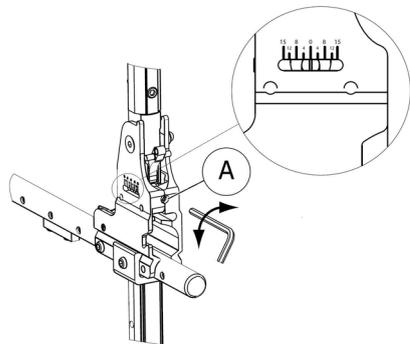
1. Die Einstellung des Rückenlehnenwinkels erfolgt mithilfe der Stellschraube (A).
