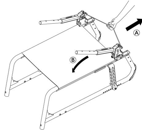
3. Ziehen Sie die Zugschnur **A** an der Rückseite des Rollstuhls nach oben. Die Rückenlehne **B** klappt nach vorne.
