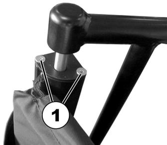
Schrauben (1) wieder in die Abdeckungen an den Enden der Rückenlehnenrahmenrohre einsetzen und festziehen.
