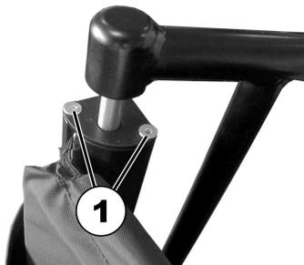
Die Schrauben (1) lösen und abnehmen, die die Abdeckungen an den Enden der Rückenlehnenrahmenrohre befestigen.
