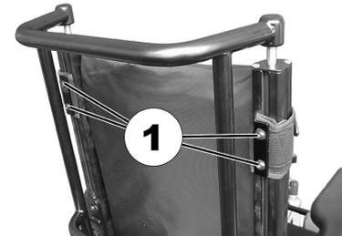
1. Die Schrauben (1) lösen.
