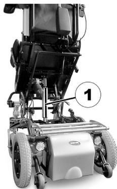
Der Steuerungskasten (1) für die Ausfahrbegrenzung der Hebevorrichtung befindet sich unter dem Sitz.
