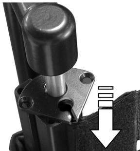
Rückenlehnschlinge und, falls erforderlich, Fixierungsstange wieder in den Rückenlehnenrahmen schieben.
