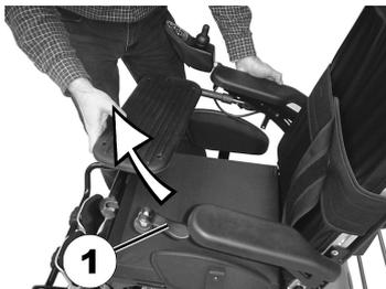
Lösen Sie die Schnelllösebefestigung (1).
